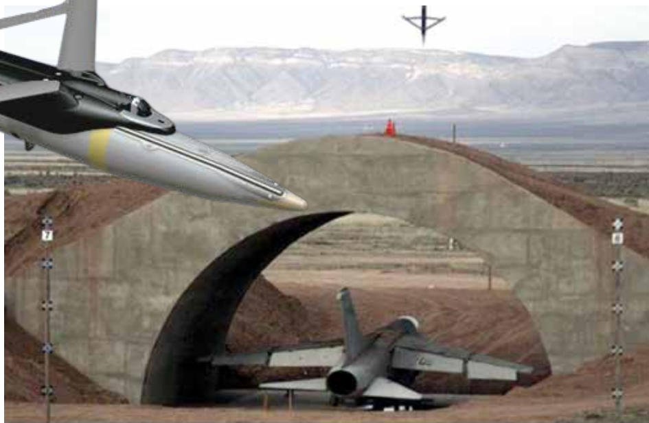
Ačkoli vítr či jiné vlivy počasí ovlivňují kurz letící střely GLSDB, naváděcí systém na bázi GPS/INS jej dokáže korigovat a zajišťuje přesnost dopadu do jednoho metru od zvoleného cílového bodu. Na sérii snímků ze zkoušek je dobře vidět průnik bojové části SDB z odolného úkrytem letounu.
