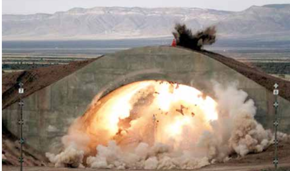
Ačkoli vítr či jiné vlivy počasí ovlivňují kurz letící střely GLSDB, naváděcí systém na bázi GPS/INS jej dokáže korigovat a zajišťuje přesnost dopadu do jednoho metru od zvoleného cílového bodu. Na sérii snímků ze zkoušek je dobře vidět průnik bojové části SDB z odolného úkrytem letounu.
