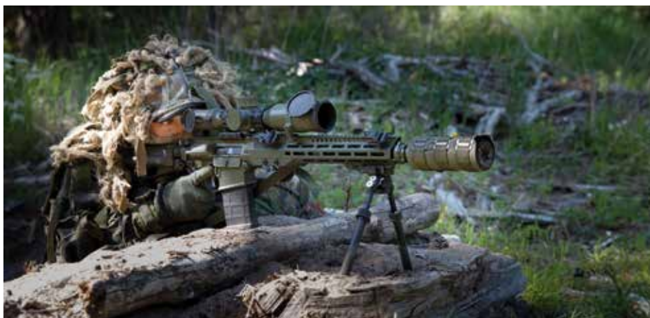
Finský voják s puškou TKIV 23 vybavenou puškohledem Steiner M7Xi 2,9-20×50, předpažbím standardu M-LOK pro montáž příslušenství, dvojnožkou Magpul a tlumičem hluku výstřelu Ase Utra. Zbraň používá střelivo 7,62×51 mm NATO, váží 3,9 kg (7,5 kg s veškerými doplňky a plným 20ranným zásobníkem) a její délka se pohybuje v rozmezí 880–965 mm (bez tlumiče; s tlumičem 1 080–1 165 mm).
