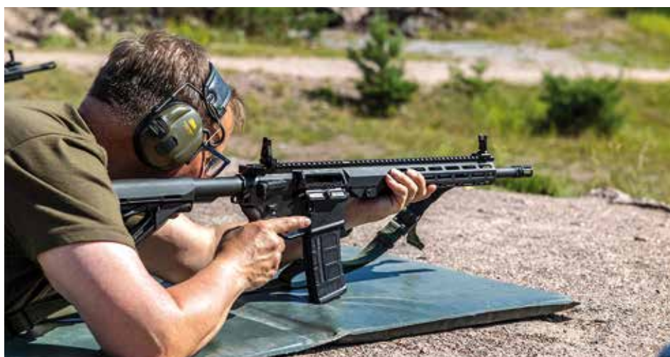
Finský voják s puškou TKIV 23 vybavenou puškohledem Steiner M7Xi 2,9-20×50, předpažbím standardu M-LOK pro montáž příslušenství, dvojnožkou Magpul a tlumičem hluku výstřelu Ase Utra. Zbraň používá střelivo 7,62×51 mm NATO, váží 3,9 kg (7,5 kg s veškerými doplňky a plným 20ranným zásobníkem) a její délka se pohybuje v rozmezí 880–965 mm (bez tlumiče; s tlumičem 1 080–1 165 mm).
