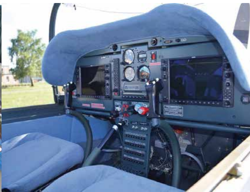
Při pohledu do kokpitu letounu Z-142C AF (vlevo) je zřejmé, že analogové přístrojové vybavení je poplatné době před 30 lety. Naproti tomu pořízované Z-242 L a Z-143 LSi (napravo) budou disponovat moderní digitální avionikou Garmin G500 TXi.
