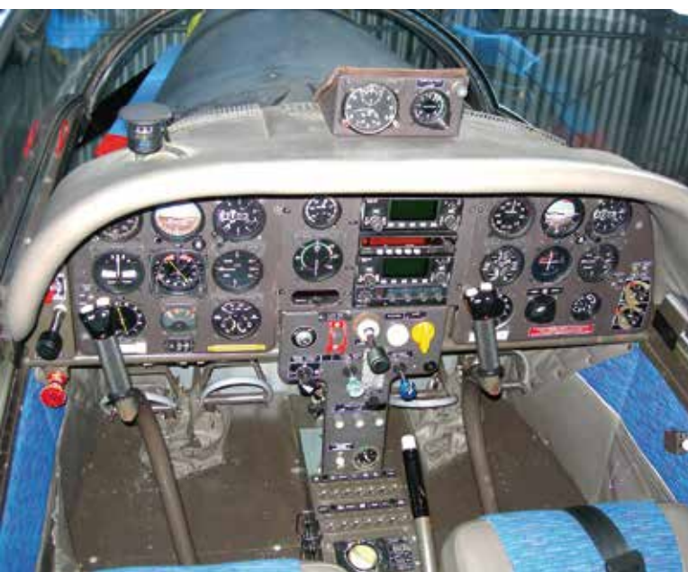
Při pohledu do kokpitu letounu Z-142C AF (vlevo) je zřejmé, že analogové přístrojové vybavení je poplatné době před 30 lety. Naproti tomu pořízované Z-242 L a Z-143 LSi (napravo) budou disponovat moderní digitální avionikou Garmin G500 TXi.
